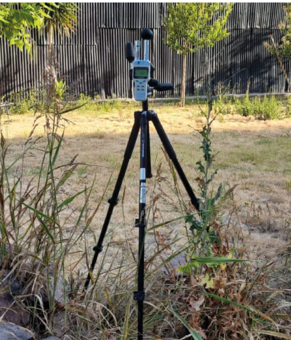
Figura 1: Sensor TENMARS WGBT instalado a 1,5 m de altura con un trípode
