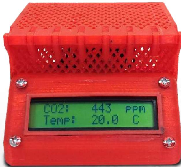
En esta actividad se puede construir un sensor que, una vez realizada la calibración, permite medir concentraciones de CO<sub>2</sub> en partes por millón (ppm). Con este dato se puede monitorear la calidad del aire que se respira al interior de espacios cerrados, como una sala de clases o una habitación de la casa.
