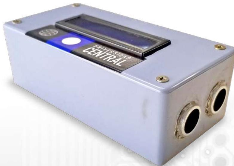
En esta actividad se construirá una regla digital de tamaño reducido, capaz de medir la distancia de objetos desde 2 cm hasta cerca de 4 metros, mostrar las mediciones a través de una pantalla LCD y enviar los datos a otro dispositivo vía bluetooth (opcional).
