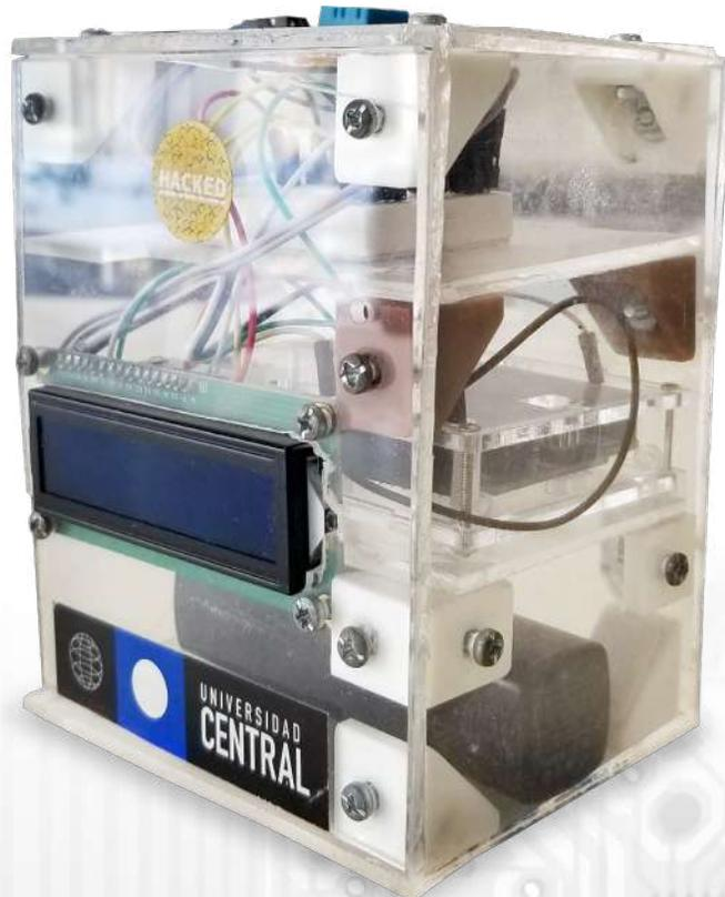
En esta actividad se puede construir una microestación de monitoreo ambiental autónoma. El diseño propuesto será capaz de monitorear temperatura, humedad relativa del aire e intensidad de luz, valores que podrán ser posibles de visualizar por medio de una pantalla LCD. La autonomía estará dada por la batería externa que conecte a la microestación, permitiendo medir en espacios abiertos con duración prolongada.
