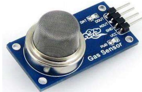
Figura 2. Pines para conexión eléctrica del sensor MQ-135. Dependiendo del fabricante, puede variar el orden de los pines en el módulo sensor.
