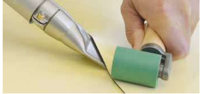
Soldadura a solapa simplificada.
