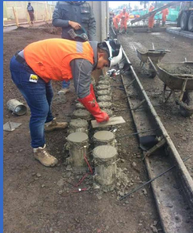
Colocación de sensor de madurez dentro de una probeta de control
