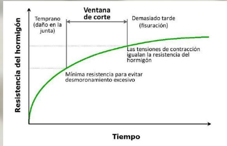
Consistencia de las mediciones de madurez y el potencial para la definición de los tiempos de corte en las juntas
